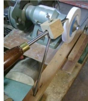
Gouge à creuser ou à profiler : j'ai un bon résultat avec ou sans contre dépouille et surtout l'affûtage est rapide et toujours au même angle donc pas d'usure importante des gouges.
